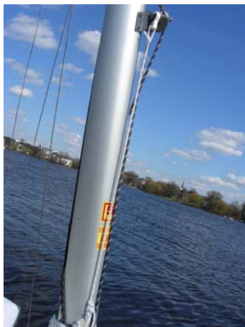
Persenning wird nach oben zum Spibaumbeschlag gespannt
