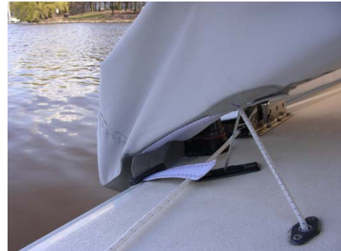
Klettband unter der Plane, beidseitig auf Höhe der Unterwanten. Beim schließen maximal dicht ziehen!
