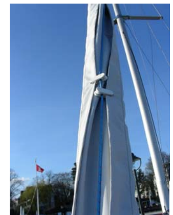
Klettband unter der Plane, beidseitig auf Höhe der Unterwanten. Beim schließen maximal dicht ziehen!
